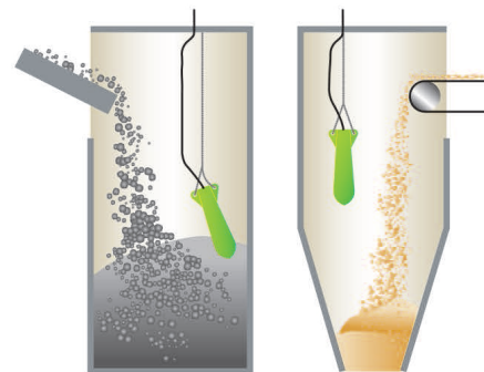
料位上限檢測 洩槽堵塞檢測
